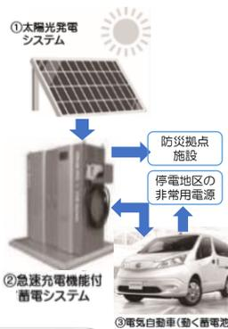
日光市では、環境にやさしく、災害に強い地域づくりを目的に、防災拠点施設に電線からの電気の供給に依存しない非常時分散電源システムの整備を進めています。
