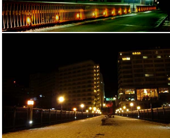
▲低い位置に連続して照明を配置している例 (ふれあい橋)
