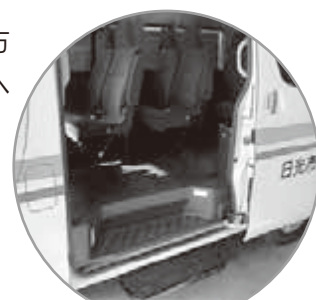
乗り降りしやすいように「補助ステップ」を設置しています
