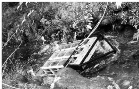
小水力発電機ピコピカにより発電した電気で街路灯を点灯しています。
