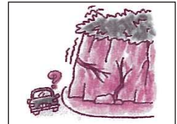
がけ・斜面に割れ目が発生
