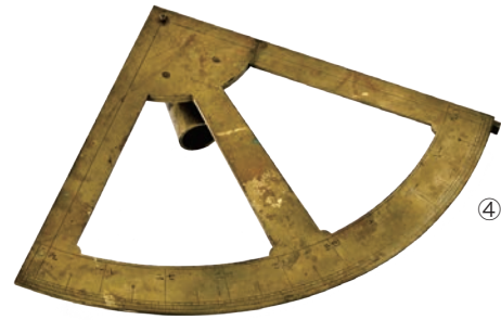
↑測量器具 (①小方儀・②全限儀・③分度矩・④象限儀)
