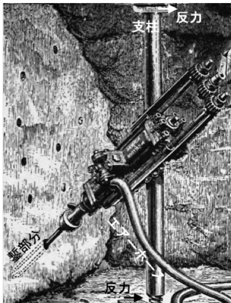
図-5 圧気を動力とする鑿岩機
