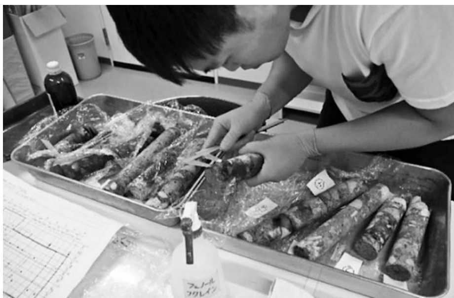
写真－ 20 コアの中性化具合の計測
