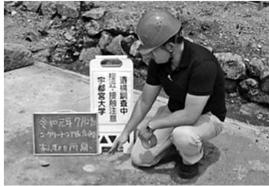
写真－ 18 コア抜き箇所確認調査
