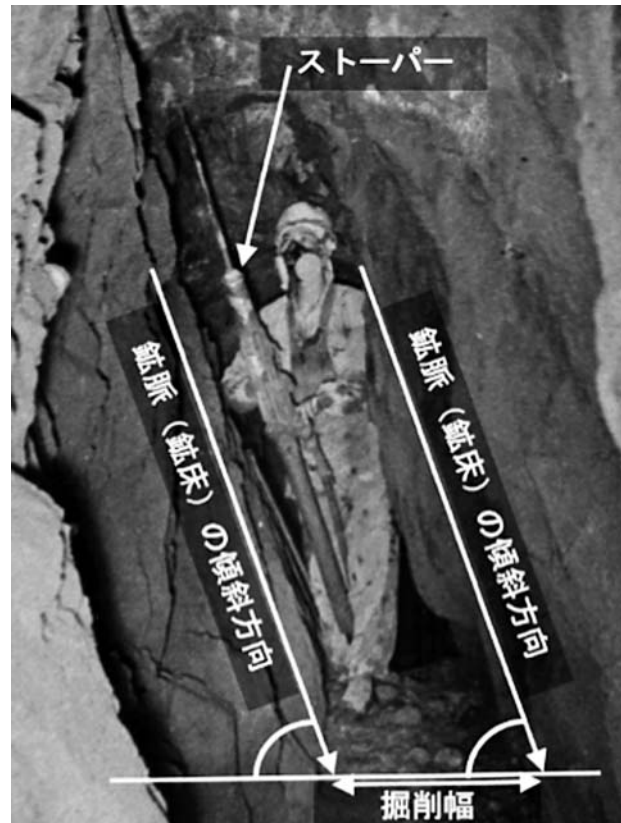
写真－7 ストーパーによる階段掘りの例（足尾銅山）
