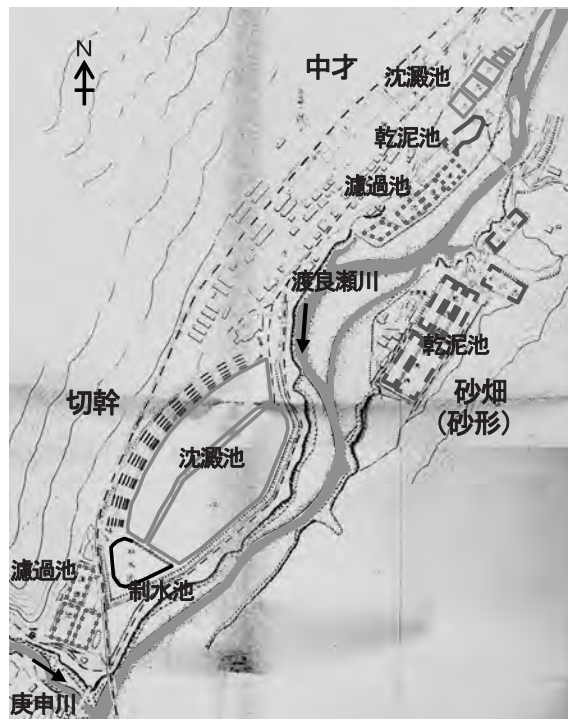
図-9 通洞の浄水施設(中才と切幹) 76)
