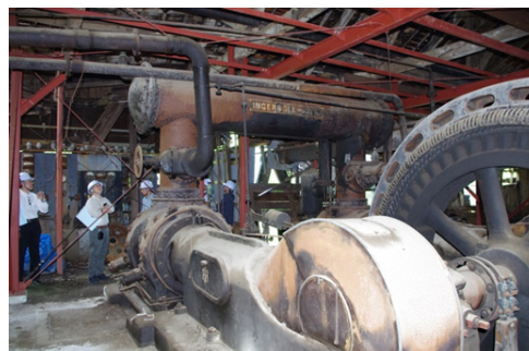
写真-2 本山動力所の内部と残存する圧気機
