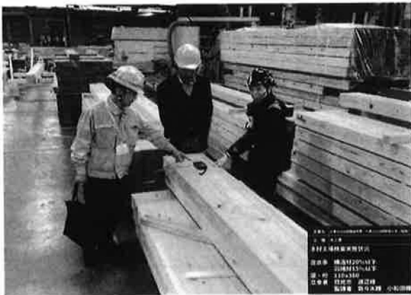
写真-1 含水率検査実施状況
