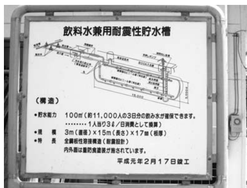
飲料水兼用耐震性貯水槽（市役所第4庁舎前）
