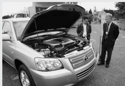
日光水素エネルギー普及促進事業 燃料電池自動車は、燃料電池からの電気をエネルギーとして走る、クリーンで音も静かな環境に優しい自動車です。
